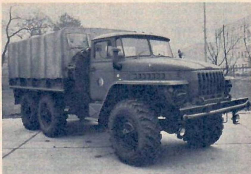
neuen in der Sowjetunion gebauten Typenreihe. Motor und Kupplung sowie Wechselgetriebe wurden vom KaMAZ übernommen. Der Motor JaMZ-740 gewährleistet ein gutes Beschleunigungsvermögen und einen relativ geringen Kraftstoffverbrauch. Ein Anlaßvorwär-
