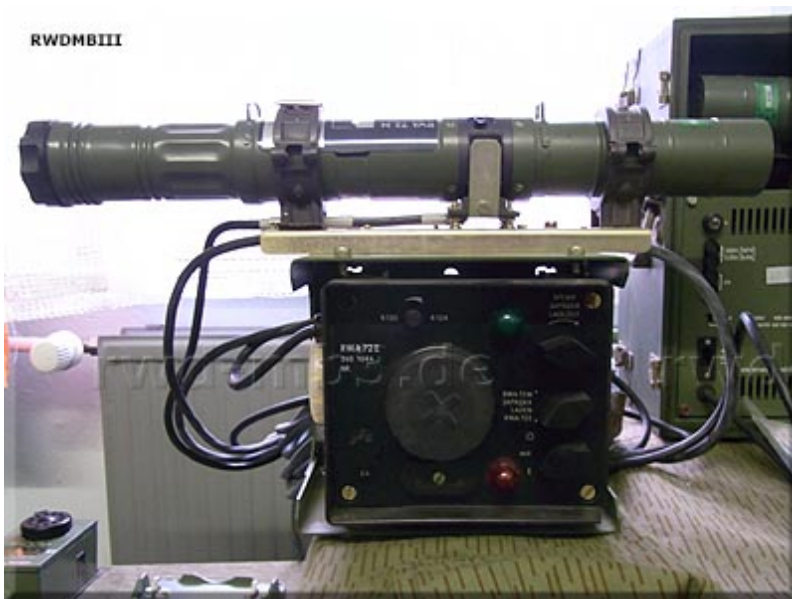
Messteil RWA-72M und Energieteil RWA-72E
