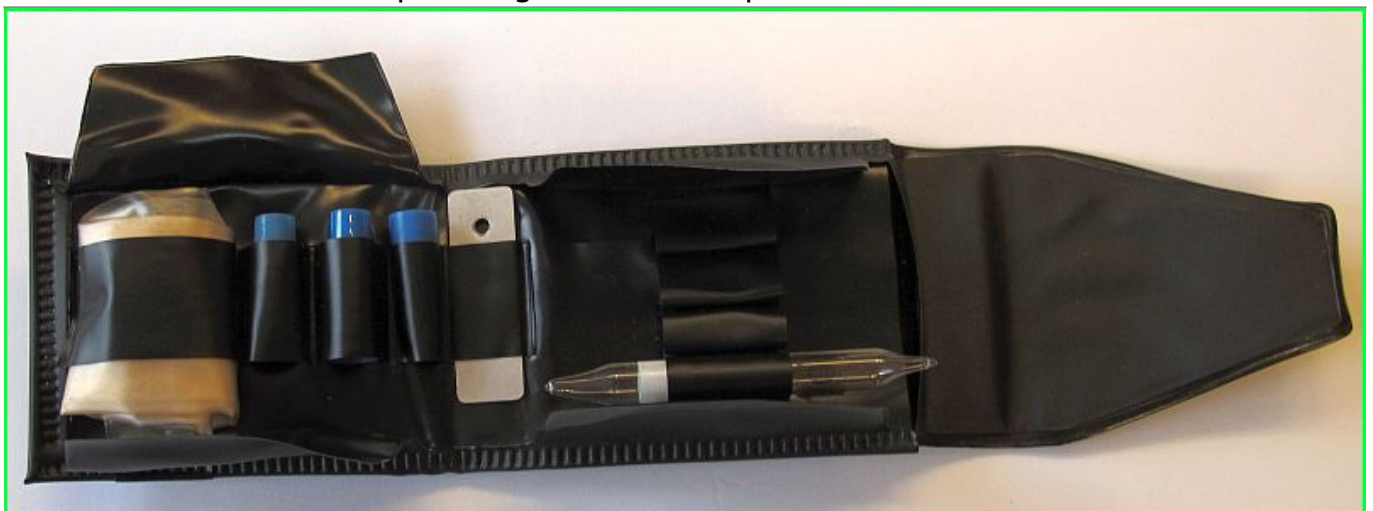
Inhalt des Atemalkoholprüfers von links: Messbeutel, Mundstücke, Ampullenöffner,
